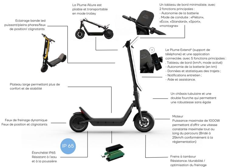
Batterie 100 % renouvelable : 2 options de batterie en fonction de l'usage : autonomie standard de 45 km ou grande autonomie de 70 km
