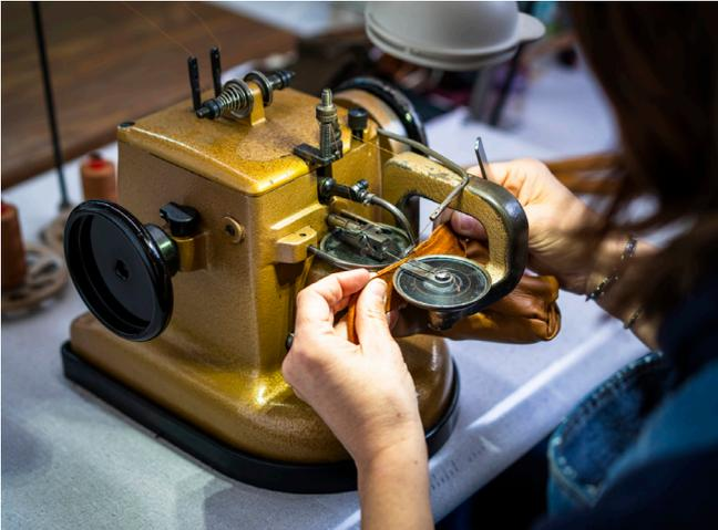
L'étape de l'assemblage permet de donner forme au gant. Les pièces, précédemment découpées, sont numérotées et rassemblées, les ornements apposés avec soin et les doublures cousues à l'extrémité de chaque doigt pour accueillir la main avec douceur et chaleur. Doublure de soie, de cachemire, d'alpaga ou de fourrure, là encore les possibilités sont nombreuses!
