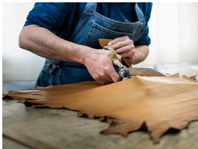
Un patron cartonné permet la découpe des peaux (dépeçage). Le cuir, étiré dans sa longueur pour correspondre à son gabarit, passe alors par l'étape de l'étavillonage
