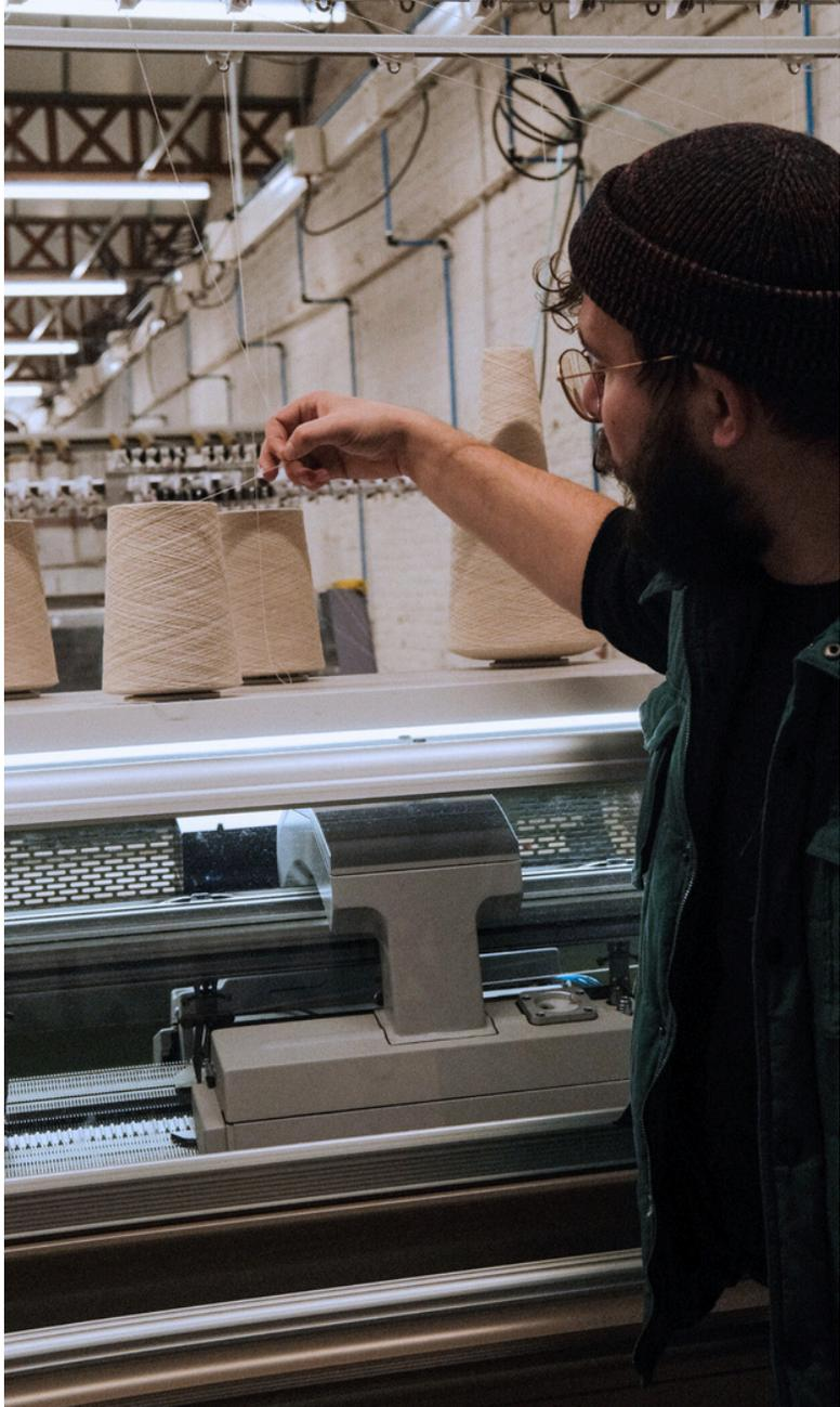
Les Trois Tricoteurs ont opté pour des machines qui utilisent une technologie de tricotage intégral : les produits sont tricotés en une seule et même pièce. Une fois sortie de la machine, il suffit de quelques minutes de finitions à la main et le vêtement est prêt à être porté ! Cette technologie novatrice a l'avantage d'éviter les déchets et la surproduction inutile.
